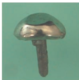
図16-1. 鑄造用磁性合金根面板 (0.927gw)
